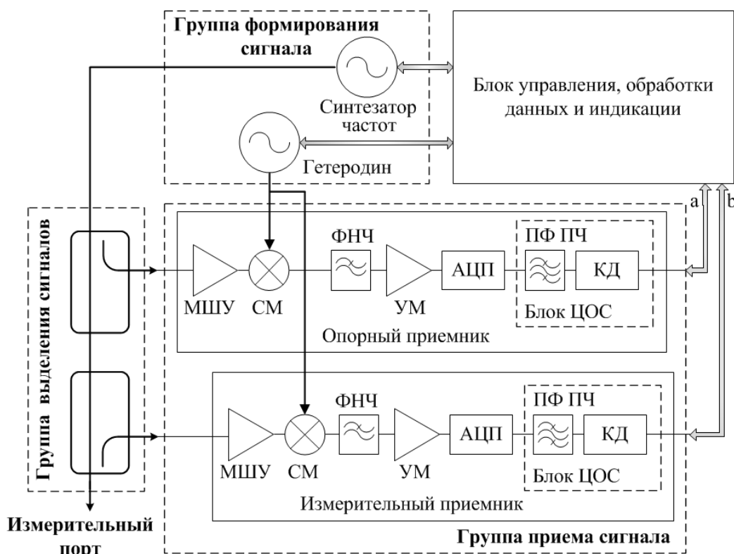
Рисунок А.1 – Структурная схема ВАЦ (рефлектометра)
