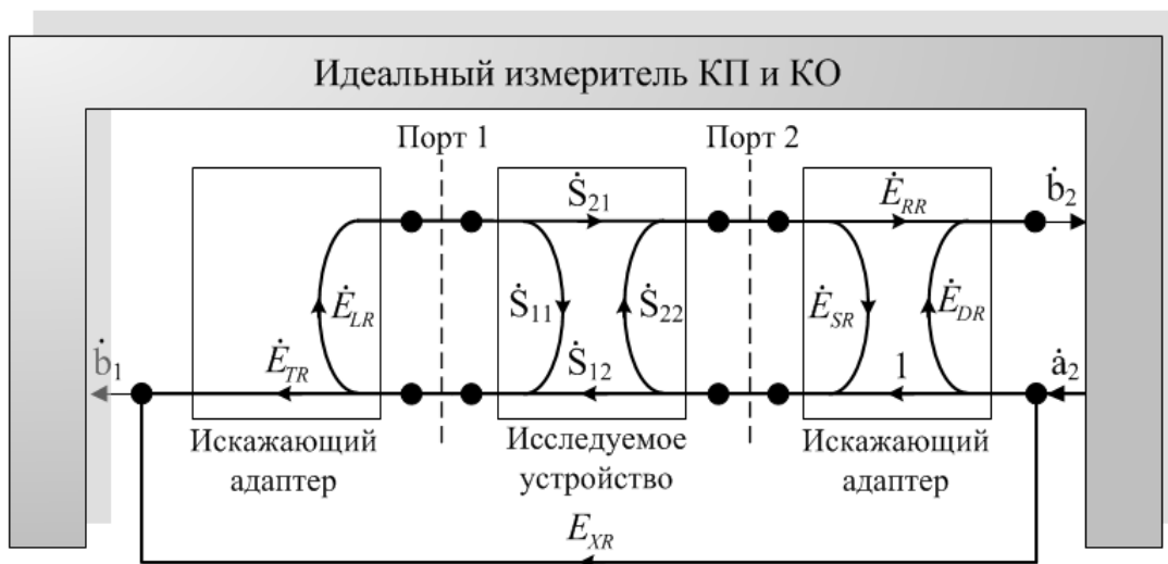
Рисунок А.13 – Модель ВАЦ при прямом направлении зондирования
